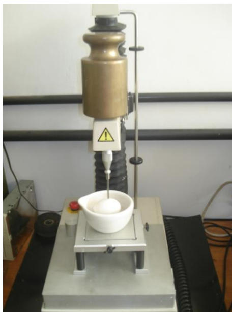
Figura 3- Equipamento TA.XT2 Texture Analyser utilizado para a análise de resistência da casca dos ovos. Arquivo pessoal.
