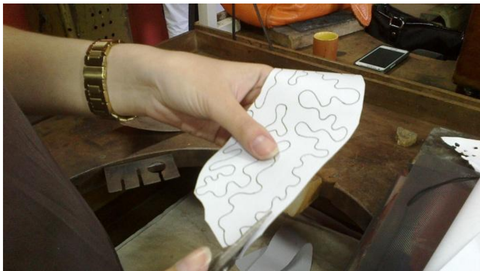
Figura 15 - Corte de molde para posterior corte no metal de uma peça única
