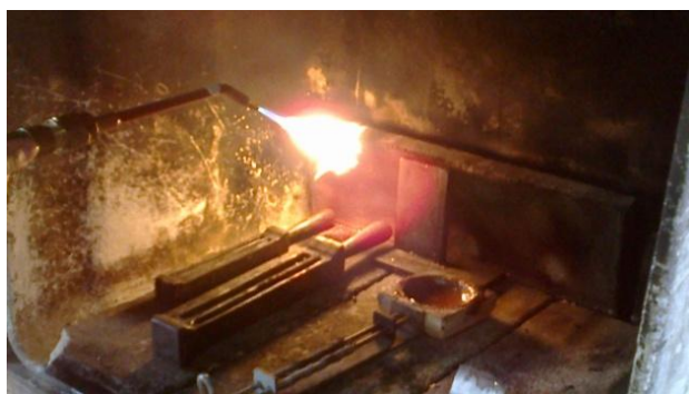
Figura 13: Fundindo o metal – preparação da liga de prata
