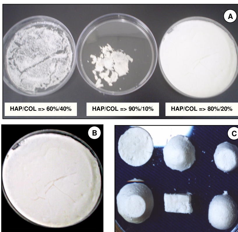
Figura IV.2 – Fotografia dos compósitos com diferentes proporções de HAP/COL (A); compósito C1 na proporção 80%/20% após liofilização (B); e variados modelos obtidos do compósito em formas de silicone (C).
