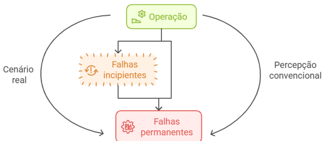
Figura 1.3 – Diagrama comparativo da evolução de falhas de isolamento: cenário com detecção de falhas incipientes versus percepção convencional sem identificação dessas falhas (Adaptado de (IBRAHIM et al., 2024)).
