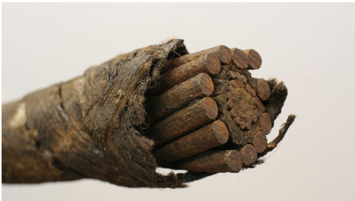
Figura 2.1 – Cabo elétrico do final do século XIX que utilizava fibra de látex gutta-percha como material de isolamento.
