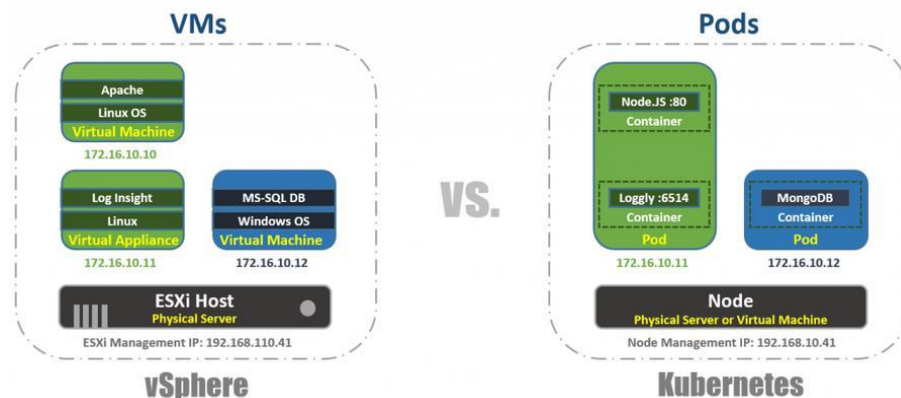
Figura 10 – Virtualização tradicional com o uso do VMware vSphere versus o uso de Kubernetes como orquestrador de contêineres.
