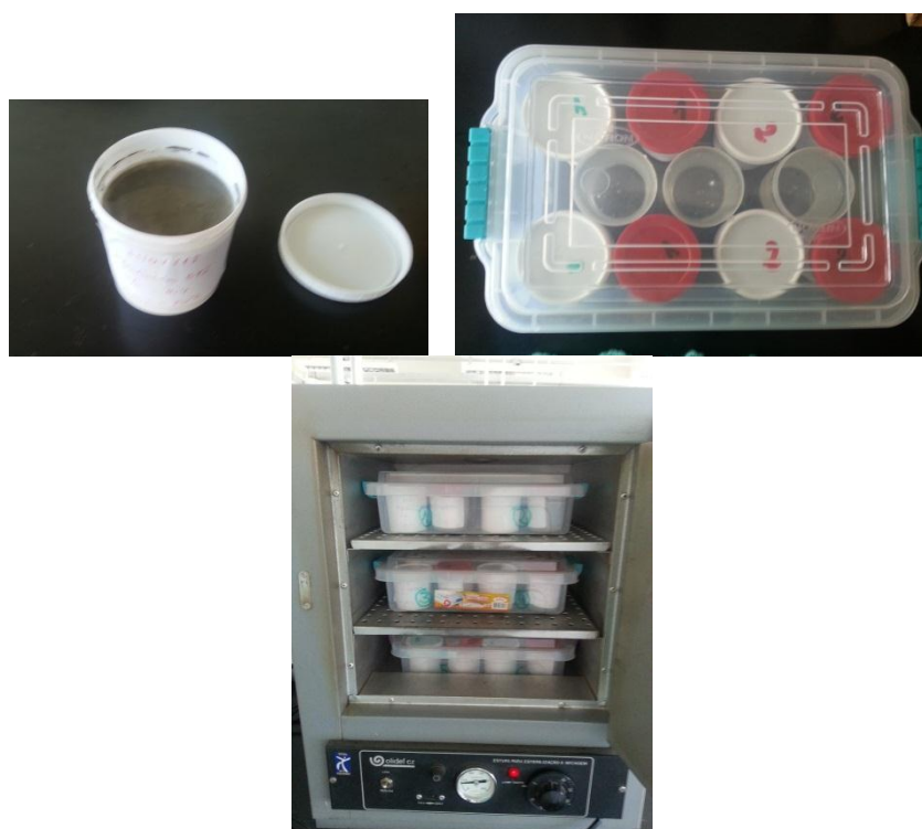
Figura 4.2 – Amostra da pasta cimentícia moldada em recipiente de plástico e curada em estufa durante 30 dias a 60 °C.
