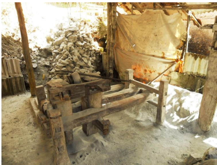
Figura 8: Torno movido à água, posse do senhor Geraldo José Teixeira. Foto: Autora.
