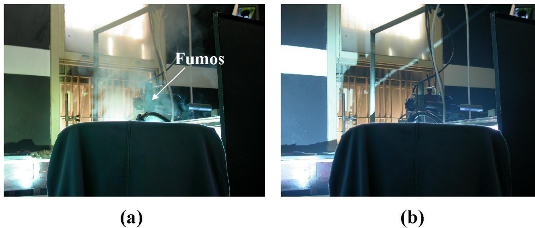
FIGURA 6.11 – Foto da região próxima ao arco durante a soldagem com operação em CV (velocidade de alimentação: 7 m/min). Condição (a) instável e (b) estável. Observar a diferença da quantidade de fumos formada.
