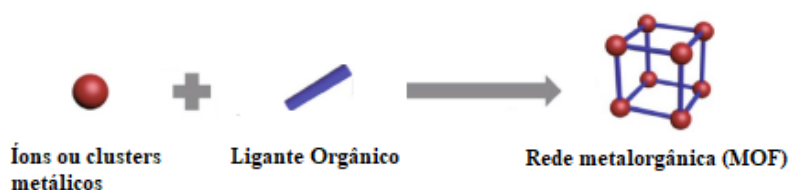
Figura 3: Esquema de construção para uma rede metalorgânicas. Fonte: [5].
