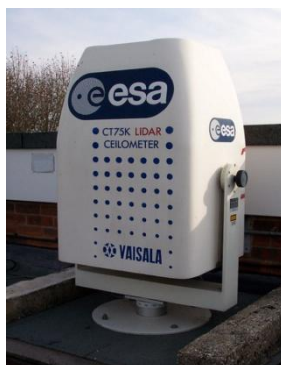
Figura 2.9 - Ceilometro Vaisala para medições em nuvens (Fonte: Vaisala.com)
