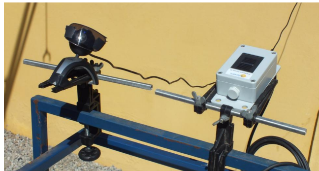
Figura 4.6 Montagem de uma câmera com 2 graus de liberdade em paralelo ao medidor de irradiância para monitorar a cobertura por nuvens que modula a irradiância. Fonte: Elaborada pelo autor
