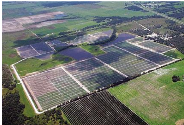
Figura 1.11 Sombras de nuvens varrem a planta solar de 25MW de DeSoto na Florida, Estados Unidos. Fonte: Moss.com
