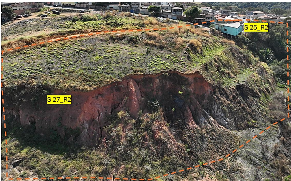
Figura 8 - Área com predisposição a movimento de massa, queda e rolamento de blocos na Vila Epa
