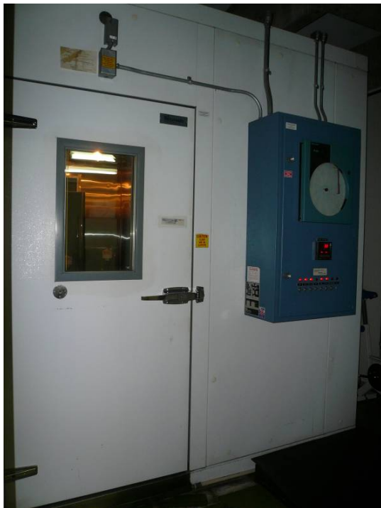
FIGURA 32 - Câmara bioclimática do LAFISE, utilizada na aferição dos termômetros de globo utilizados. Fonte: Arquivo pessoal da autora.
