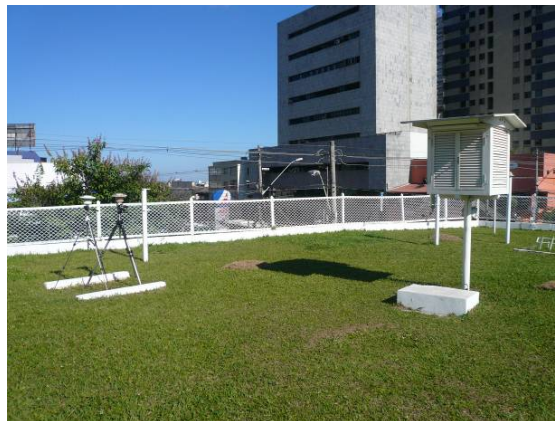
FIGURA 38 - Posicionamento dos abrigos, com e sem revestimentos, com relação ao abrigo do 5º DISME/INMET para o procedimento de aferição. Fonte: Arquivo pessoal da autora.
