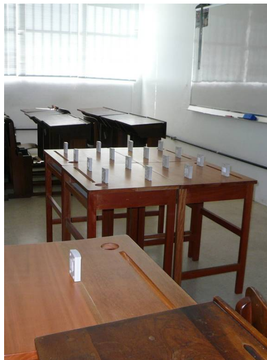
FIGURA 26 - Organização dos dezessete data loggers para o procedimento de aferição dos mesmos. Fonte: Arquivo pessoal da autora.
