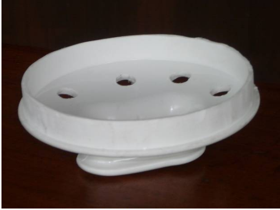
FIGURA 18 – Corte e lixamento da lateral do plug de esgoto. Fonte: Arquivo pessoal da autora.
