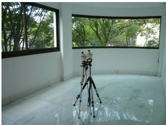
FIGURA 30 - Organização do ambiente para aferição dos termômetros de globo cinza de 40mm. Fonte: Arquivo pessoal da autora.
