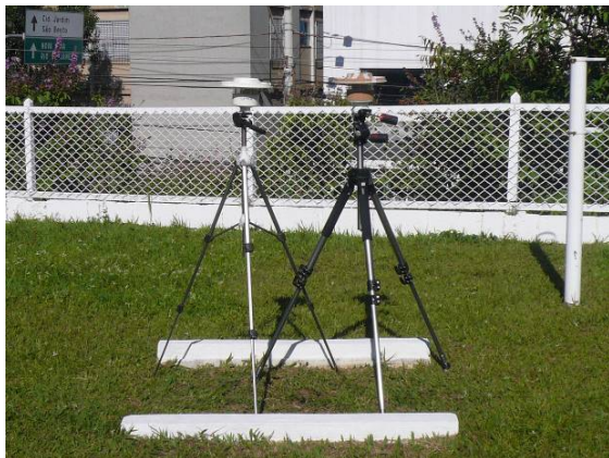
FIGURA 37 - Abrigos montados sobre tripé, a 1,1m do solo, com e sem revestimentos, para o procedimento de aferição no 5º DISME/INMET. Fonte: Arquivo pessoal da autora.
