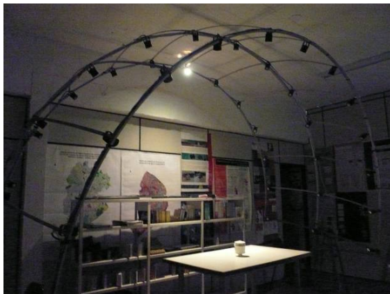
FIGURA 35 - Teste do abrigo de 100mm de diâmetro, inicialmente sem a proteção da peça antiinfiltração utilizada como pára-sol, realizado no heliodon do LABCON/UFMG. Fonte: Arquivo pessoal da autora.
