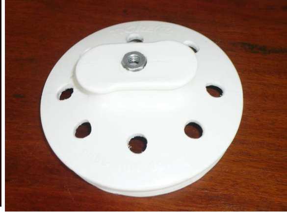
FIGURA 19 – Furação da base do abrigo e encaixe da porca sextavada de 1/4". Fonte: Arquivo pessoal da autora.
