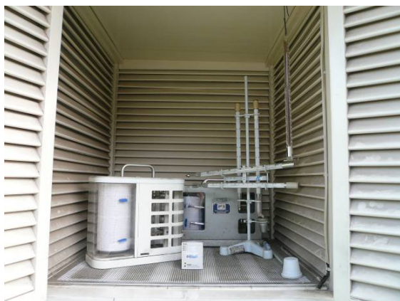
FIGURA 27 - Localização dos data loggers no interior do abrigo meteorológico do 5º DISME/INMET. Fonte: Arquivo pessoal da autora.
