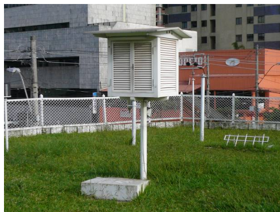
FIGURA 28 - Abrigo meteorológico do 5º DISME/INMET, com os data loggers em seu interior. Fonte: Arquivo pessoal da autora.
