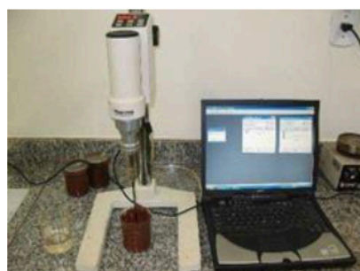
Figura 6: Reômetro Haake (VT-550) para a medição da tensão de escoamento.
