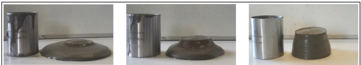
Figura 5 – Amostras de rejeitos de platina e paládio com diferentes teores de umidade sob testes de abaixamento
