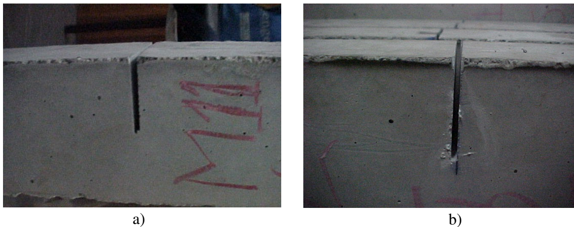
FIGURA 4.3 Vigas após o corte do entalhe: a) vigas do Método 1 b) vigas do Método 2.
