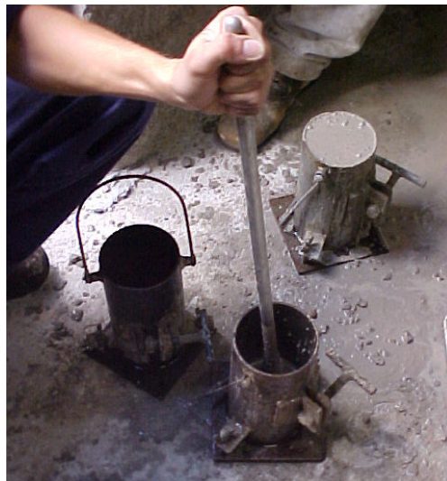
FIGURA 4.8 Modelagem de corpos-de-prova cilíndricos.
