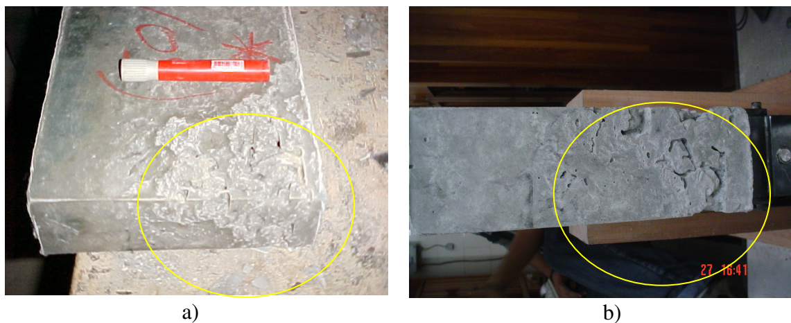
FIGURA 4.10 Exemplo da série 3, apresentando segregação: a) vista lateral da viga b) vista da parte inferior da viga.
