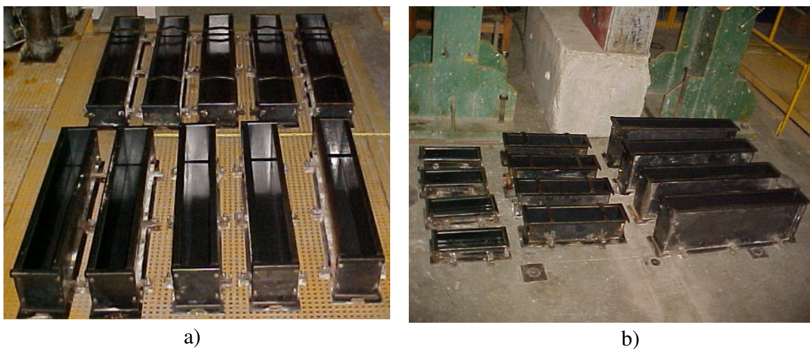
FIGURA 4.4 Fôrmas metálicas, utilizadas na modelagem das vigas:
