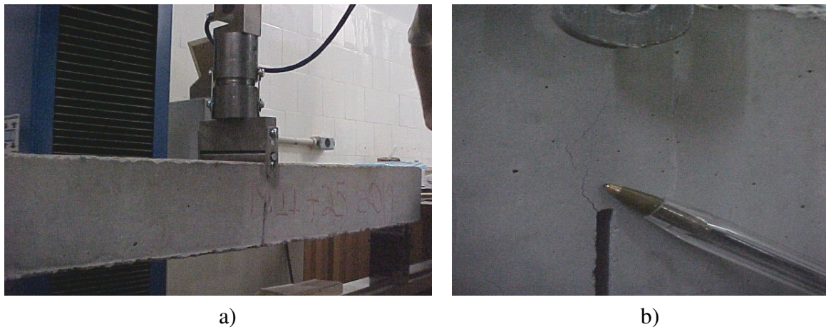
FIGURA 4.18 Viga do Método 1 sendo ensaiada:
