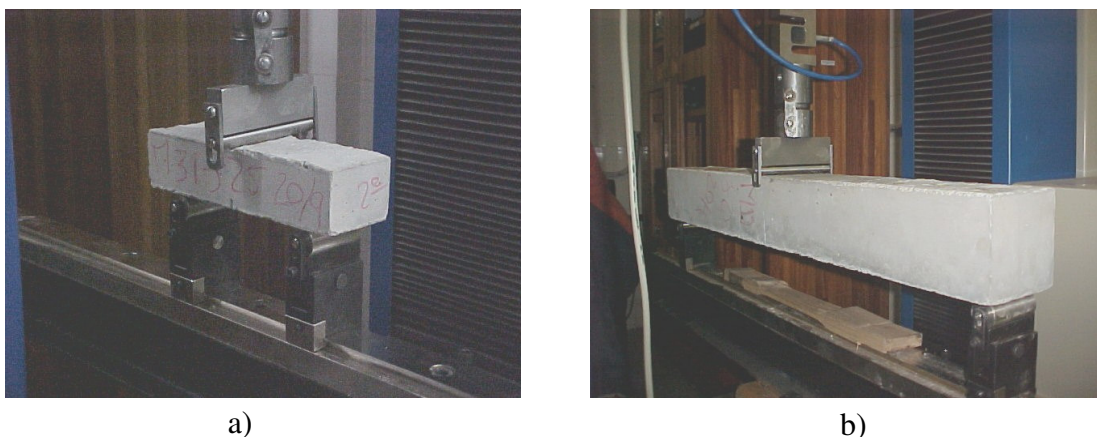
FIGURA 4.16 Ajuste do vão livre das vigas:
