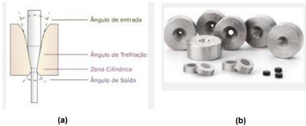
Figura 5.9: (a) Vista em corte longitudinal e (b) foto real de uma fieira uma Máquina de trefilar
