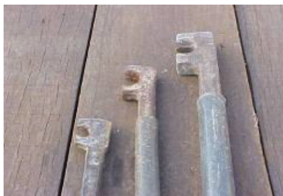
Figura 3.4 - Dobramento manual da armadura em canteiros – chaves (BOTTURA & MELHADO, 2006)
