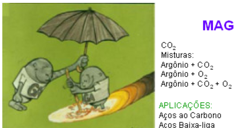
Figura 3.13 – Processo MAG onde o gás interage com a peça (Catálogo Técnico ArcelorMittal, 2010)
