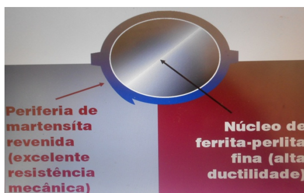
Figura 3.10 – Corte transversal de uma barra de CA50 Soldável (Catálogo Técnico ArcelorMittal, 2010)
