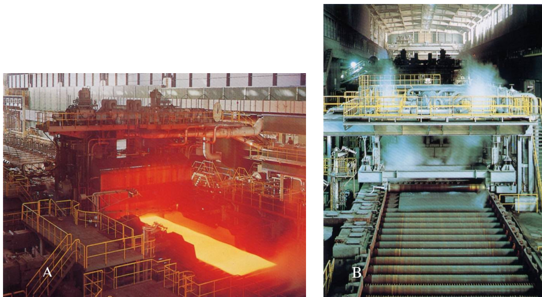
Fig. 3.3. Instalação para obtenção de aços por laminação controlada. A – Laminação controlada, B – Sistema de resfriamento rápido. Yokota T., NKK Corp. (JFE Group).
