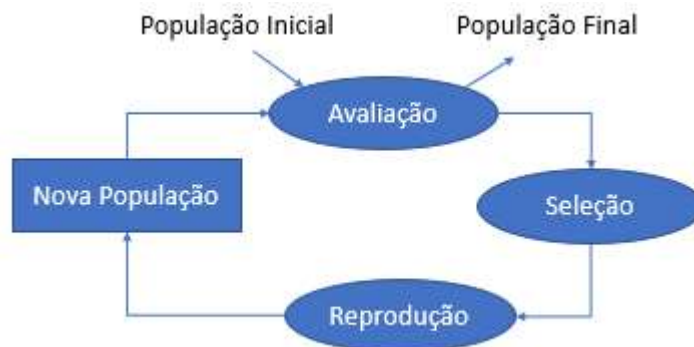
Figura 2 - Ilustração do processo de execução do algoritmo geral de programação genética
