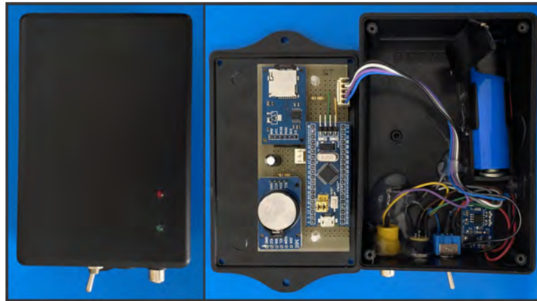
Figura 5.7: Sistema Embarcado de Coleta de Dados para Gravação de Vazões Instantâneas Residenciais. Fotos fechado e aberto.
