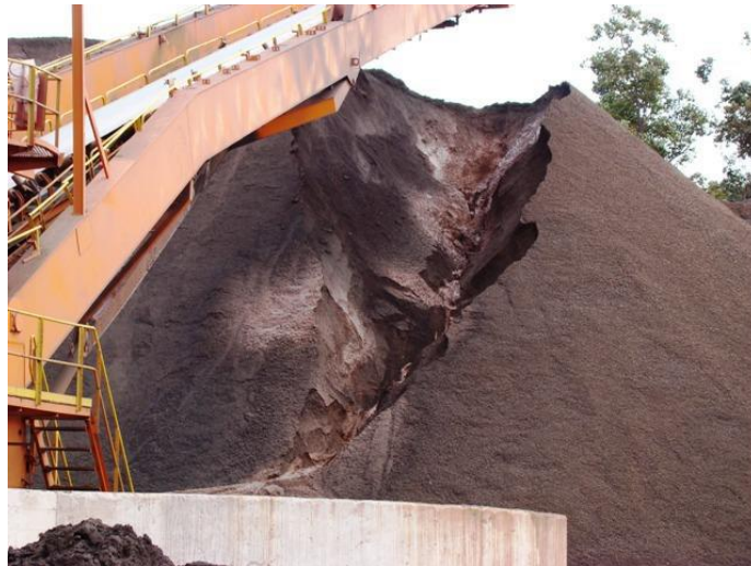
Figura1: Ruptura de pilha de estocagem de pellet feed no porto de Vitória.
