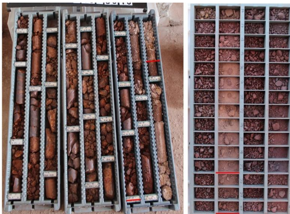
Figura 9 - Distância entre os furos: 6.81 metros. As linhas em vermelho mostram o mesmo intervalo amostral. À esquerda, o furo DDH evidenciando o granito. À direita, no furo RC, evidenciando o colúvio.
