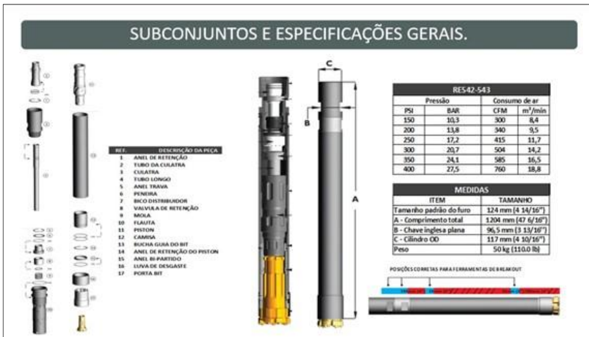
Figura 3 - Martelo RC Montado e explodido. Fonte: Geosedna Perfurações Especiais S/A
