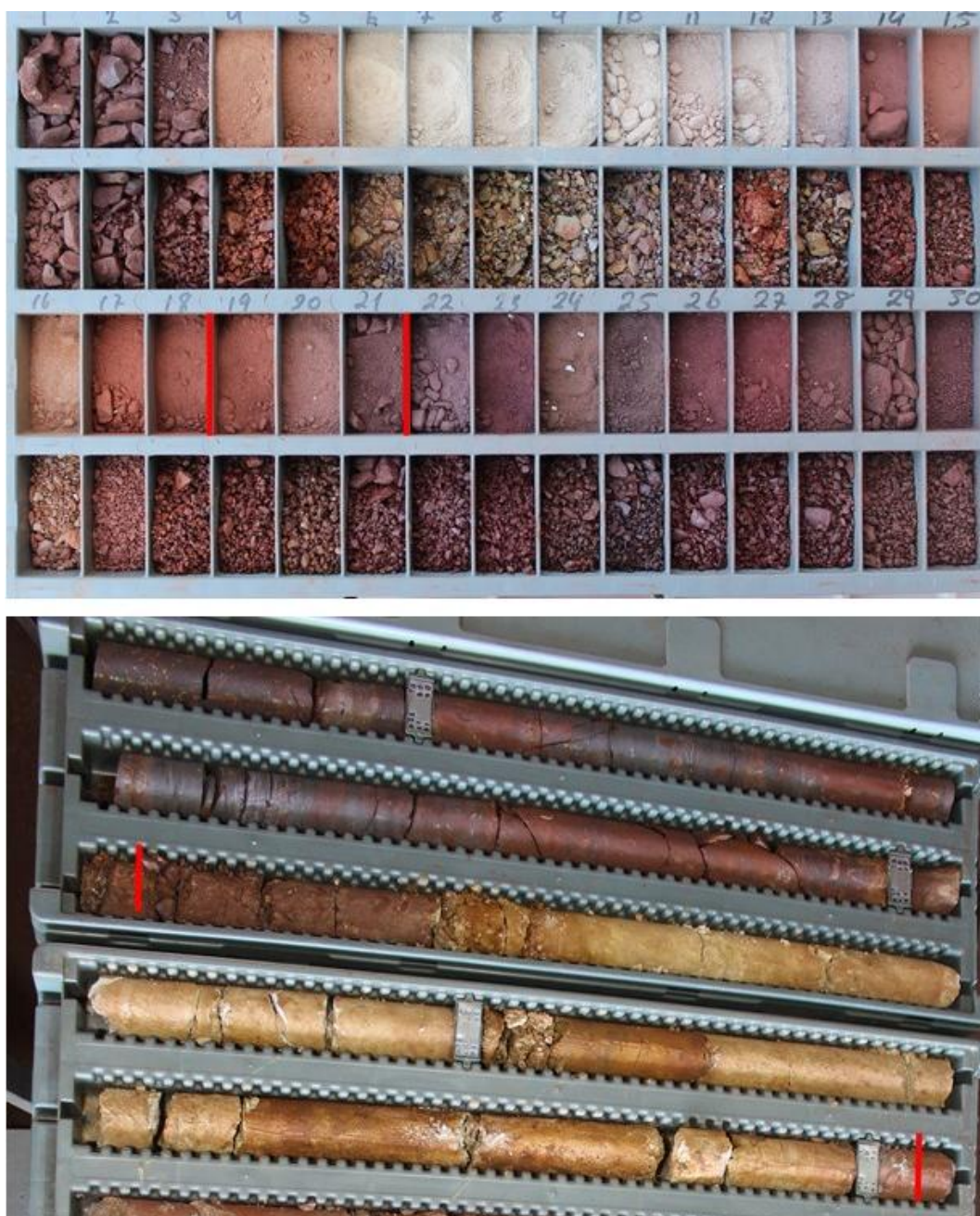
Figura 11 - amostras DDH e RC, intervalo amostral 18 a 21 m. Distância entre os furos: 3,47m. Par STC STC-FD20335 e STC-RC00335. As linhas em vermelho mostram o mesmo intervalo amostral. A figura abaixo mostra o furo DDH evidenciando o colúvio granítico. À direita, no furo RC interceptando um colúvio de minério.
