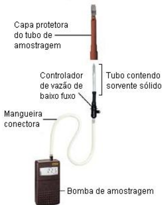
Figura 4.6 Tubo preenchido com sorvente conectado a bomba de amostragem para coleta de gases contaminados por compostos orgânicos voláteis (adaptado de SKC, 2004).
