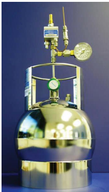
Figura 4.7 Botijão tipo Summa esférico (6L) conectado a um controlador de fluxo (Columbia Analytical Service, 2008)
