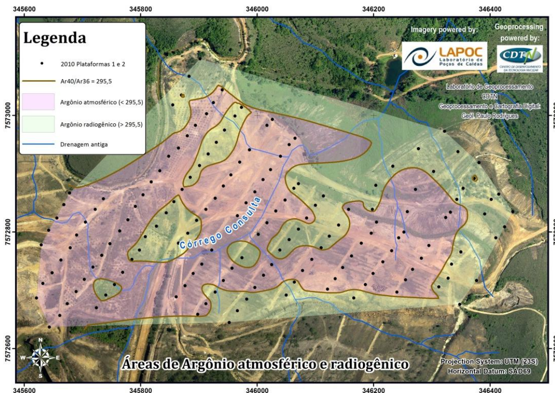
Figura 6.1 Caracterização do fluxo de ar no interior da pilha a partir da razão isotópica de argônio ( 36 Ar/ 40 Ar). Valores inferiores a 295,5 indicam presença predominante de argônio de origem atmosférica.
