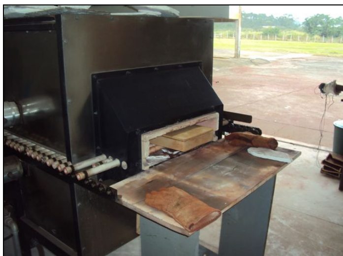
Figura 4.9 – Forno de rolos – vista frontal (saída da bandeja com o produto calcinado).
