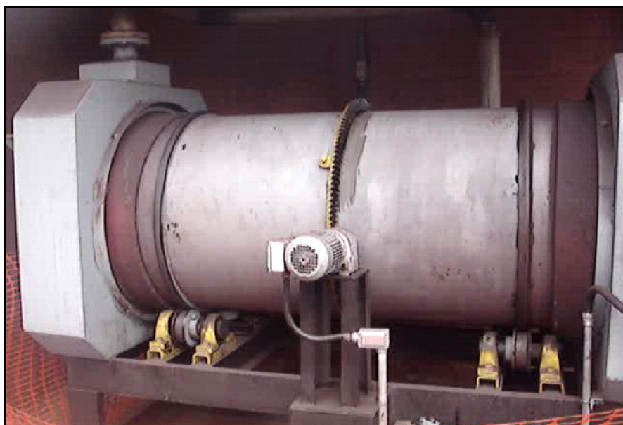
Figura 3.6 – Forno de calcinação piloto – Samarco.
