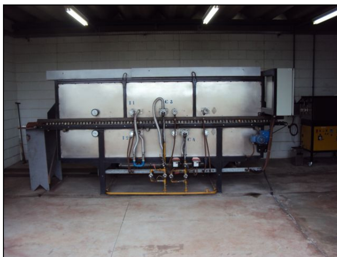
Figura 4.8 – Forno de rolos – vista lateral do forno (deslocamento no sentido da direita para esquerda).
