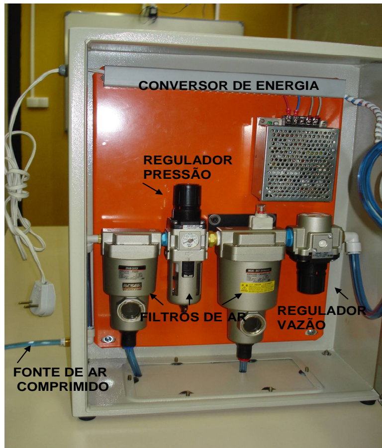
Figura. 3.3 Foto interna do projeto de insuflação e exsuflação mecânica.
