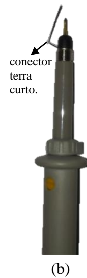
Fig. 5.5 – (a) tensão de gate e transformador sem oscilação; (b) conector terra curto.
