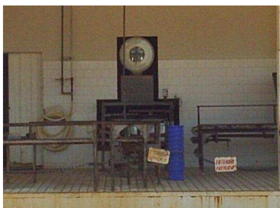
Figura 15. Laticínio cuja balança não ocupa todo o espaço à ela destinado, deixando um espaço aberto com acesso ao interior do laticínio.
