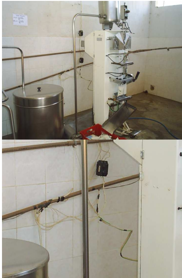
Figura 22. Fios expostos atrás do pasteurizador de laticínios que pasteurizavam e distribuíam leite em programa governamental.
