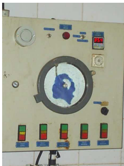
Figura 20. Termorregistor ilegal em um dos laticínios que pasteuriza leite e o distribui em programa governamental.
