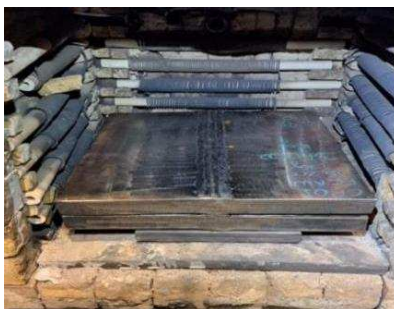
Figura 9 – TTPS: corpos de prova do processo FCAW no forno e curva térmica aplicada ao processo SAW
