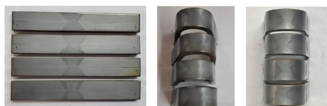
Figura 12 – Amostras do ensaio de dobramento: CP1S (não dobrado), CP2S e CP1F (após dobramento)
