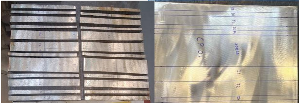
Figura 10 –Traçagem e corte das amostras para os ensaios mecânicos
