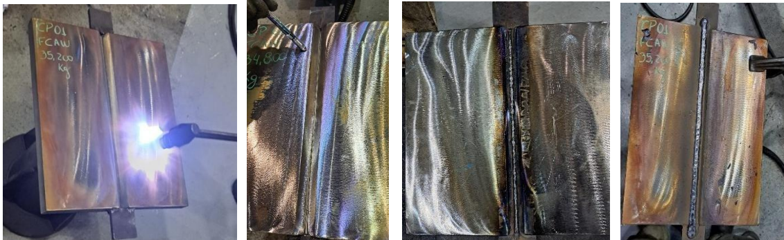
Figura 5 – Conjuntos de corpos de prova preparados para soldagem com FCAW e SAW
