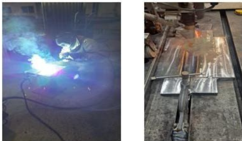
Figura 3 – Comparação da emissão de radiação entre os processos FCAW e SAW
