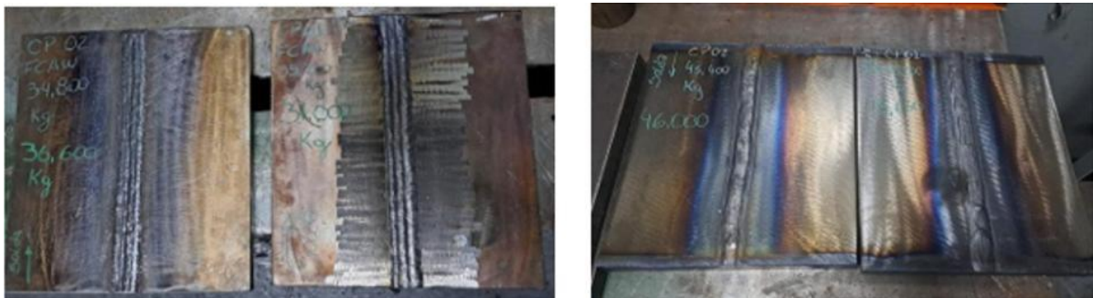
Figura 8 – Corpos de prova após soldagem completa com os processos FCAW (à esquerda) e SAW (à direita)
