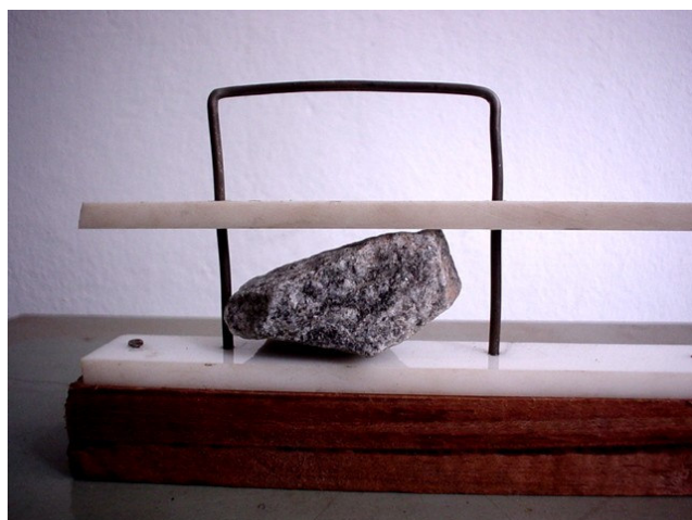
Figura 4.3 - Dispositivo construído para aplicação da norma NBR 7809, de medição das dimensões de partículas para determinação do fator de forma.
