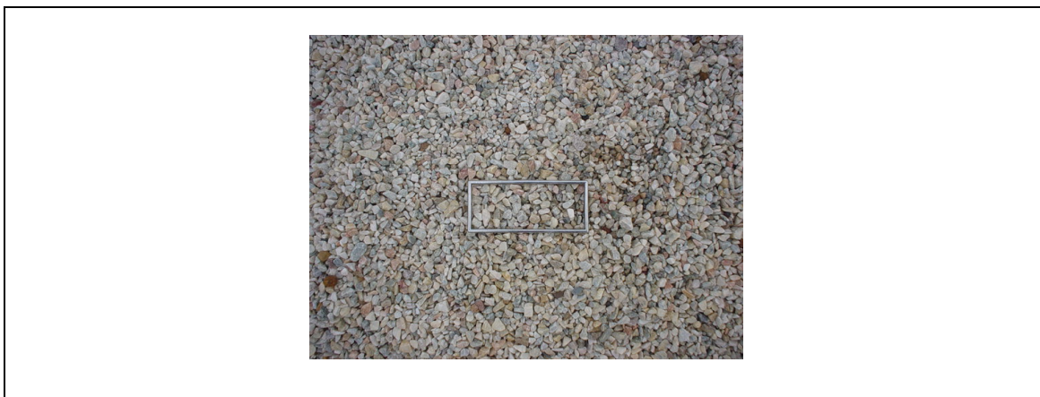
Figura 5.7 – Referência de tamanho para determinação de distribuição granulométrica através do aplicativo WipFrag para uma amostra de brita 0 de dolomita.
