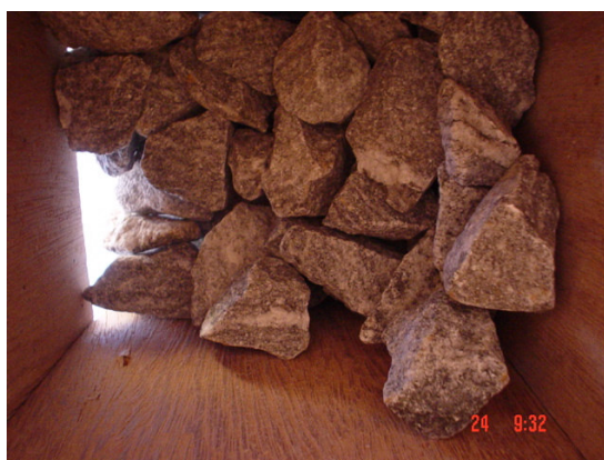
Figura 5.17 - Detalhe do arco formado na saída de descarga em ensaio com brita 2, modelo inclinado de 70°, sem joelho, 3,0m de coluna de material.
