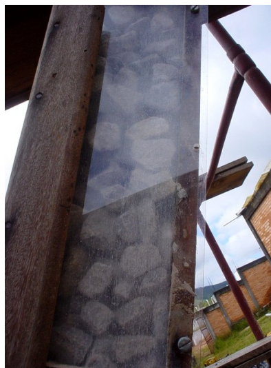
Figura 5.16 - Movimentação de material em ruptura de arco em ensaio com brita 2, modelo de passagem inclinado de 60°, joelho inclinado de 60°, 3,7m de coluna de material.
