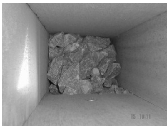
Figura 5.18 - Arco formado na alimentação do material em modelo físico de passagem, em ensaio com brita 2, passagem inclinada de 75°, 2m de enchimento, visto de baixo.
