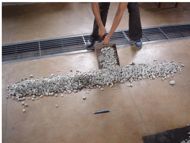
Figura 4.2 – Formação de pilha para homogeneização na determinação do índice de forma de partículas.
