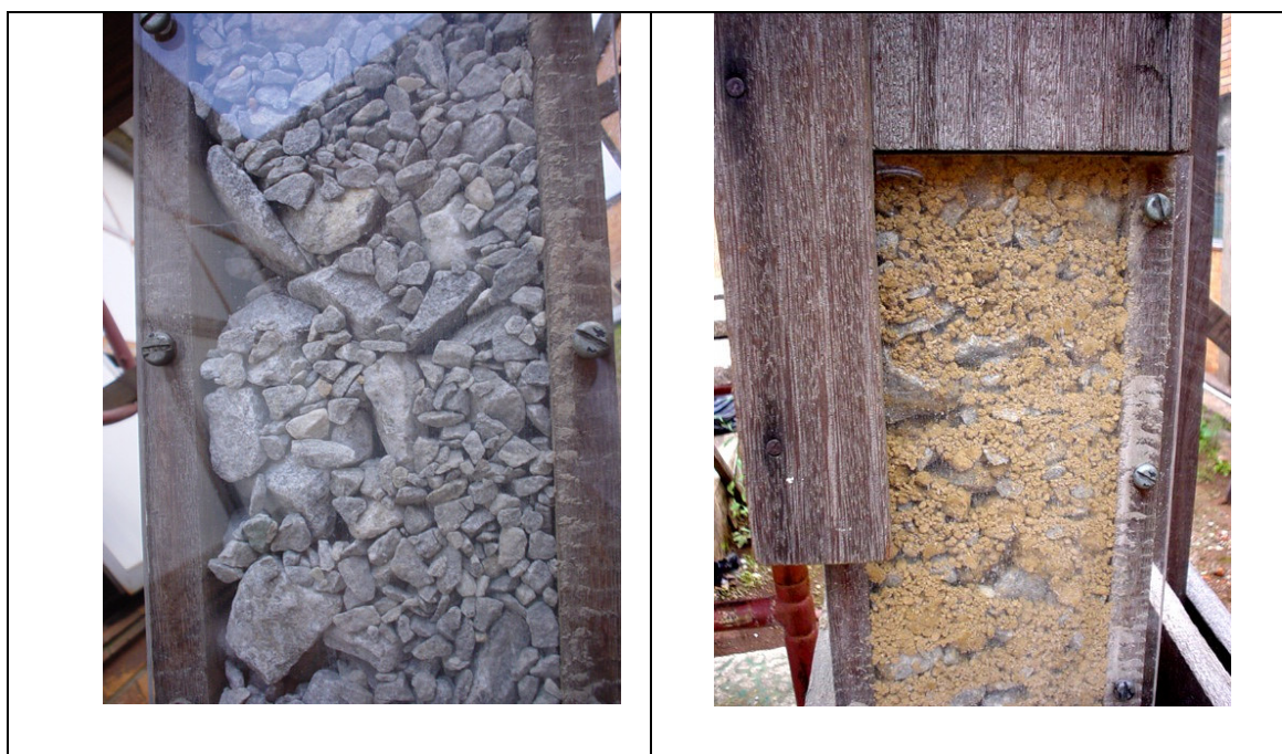
Figura 5.27 – a) Detalhe do arranjo de fragmentos antes da descarga em ensaio com mistura 1 (britas 0 e 2 de gnaiss) em modelo de passagem inclinado de 60^\circ , 2m de coluna de material; b) detalhe do arranjo de fragmentos antes da descarga em ensaio com mistura 2 (britas 0 e 2 de gnaiss, argila e água) em modelo de passagem inclinado de 90^\circ , 2m de coluna de material.
