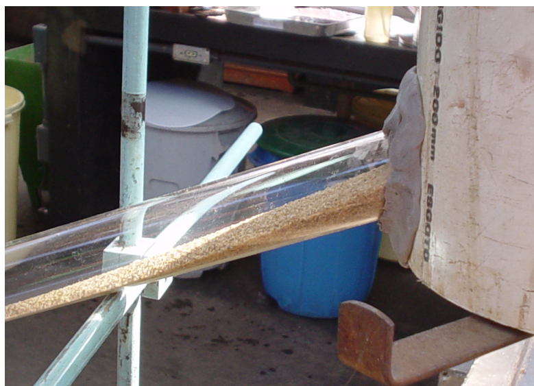
Figura 4.7 – Fotografia de ensaio de fluxo de areia em tubo inclinado.
