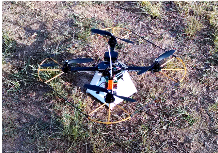
Figura 4.16: Foto do modelo do VANT disponível, o AscTec Hummingbird
