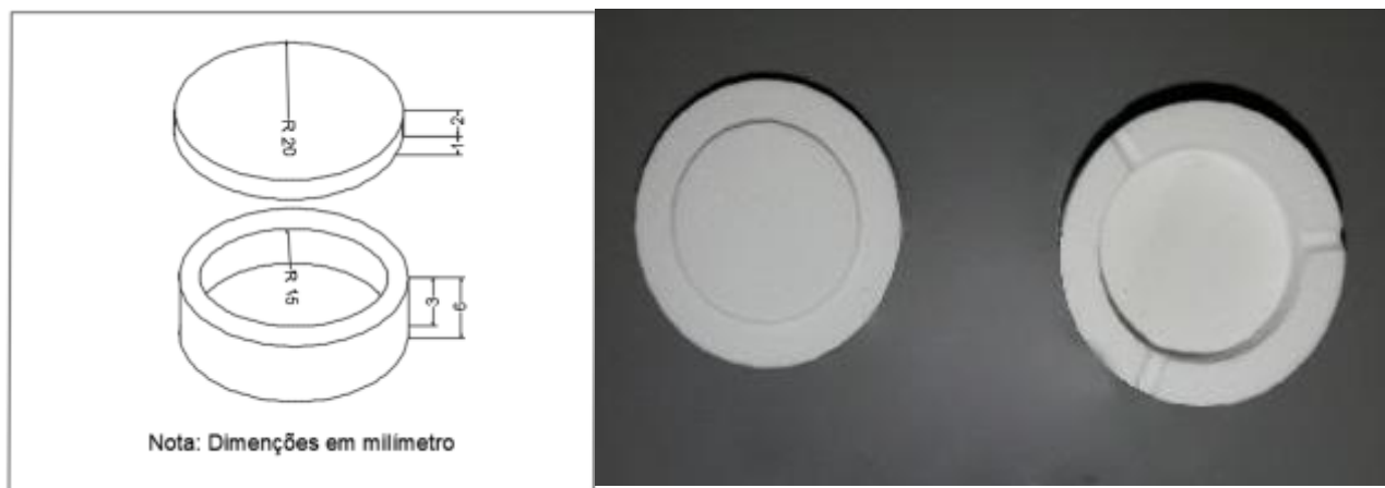
Figura 2: Modelo de corpo de prova utilizado no experimento
