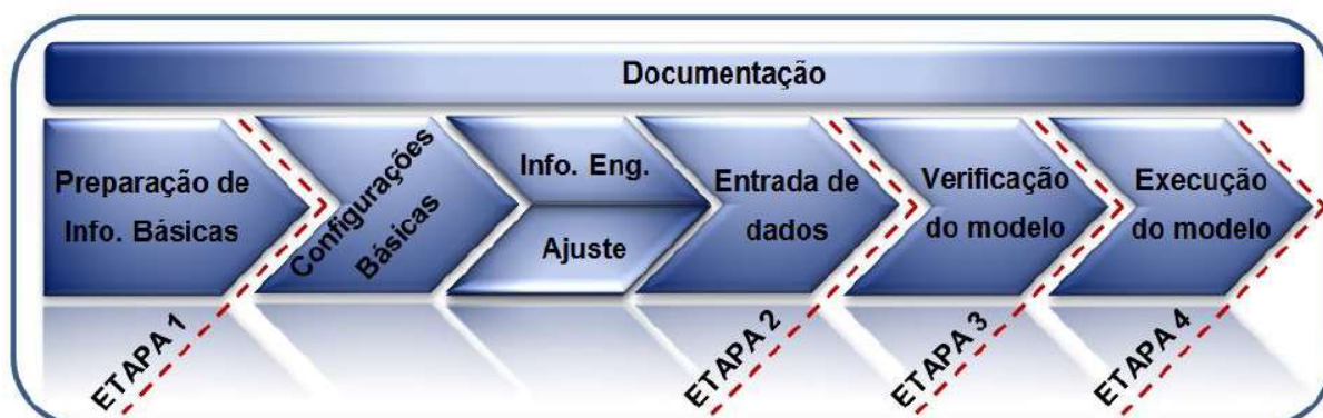
Figura 16 - Etapas para a elaboração de modelos dinâmicos de processos. Fonte: Ferreira, 2013.
