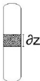
Figura 15 – Representação do volume de controle em uma coluna de adsorção. Fonte: PATRÍCIO, 2016
