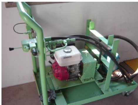
Figura 3.46 - Motobomba de emergência.
