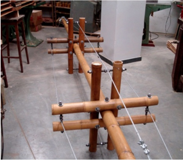
Figura 11. Configuração final da coluna híbrida. Fonte: o próprio autor.
