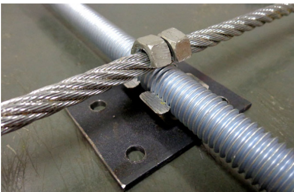
Figura 13. Sequencia de instalação e montagem do clip no cabo de aço. Fonte: o próprio autor.
