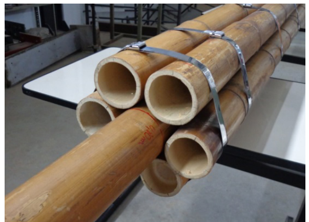
Figura 21. Aspecto da coluna montada com as cintas metálicas ao redor da mesma. Fonte: o próprio autor.
