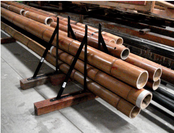
Figura 17. confeção de gabarito e pontos de apoio das barras. Fonte: o próprio autor.
