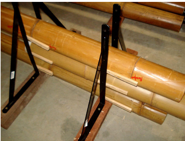
Figura 18. confeção de gabarito e pontos de apoio das barras. Fonte: o próprio autor.
