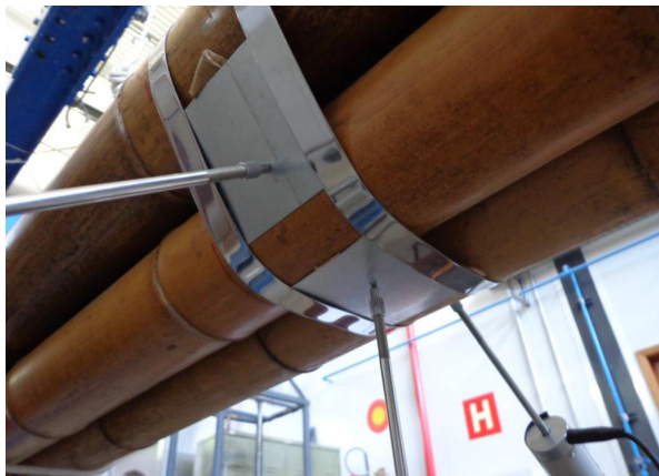
Figura 23. Instalação dos DT e da chapa equalizadora. Fonte: o próprio autor.
