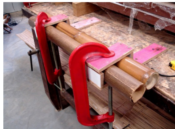
Figura 10. Sistema de gabaritos para furos dos bambus. Fonte: o próprio autor.
