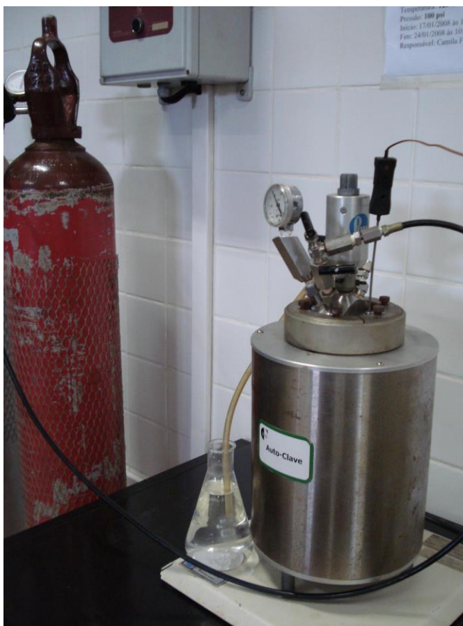
Figura 4.2: Autoclave com capacidade de 2 litros
