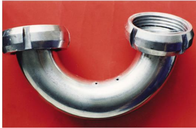
Figura 3.4: Corrosão por pite [GENTIL, 2006]
