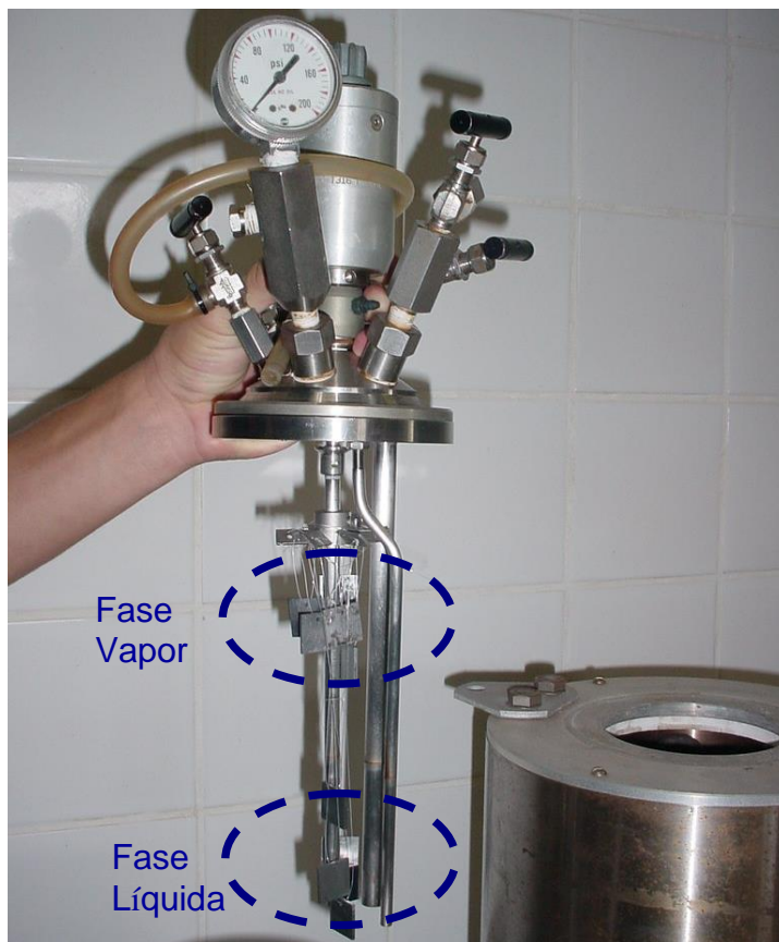
Figura 4.4: Esquema de montagem da autoclave
