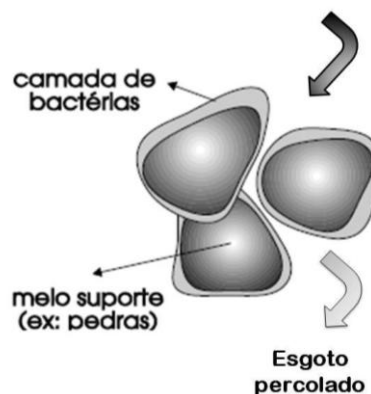
Figura 3.4: Esquema de bactérias e outros microrganismos do biofilme de sistemas aderidos de biomassa.
