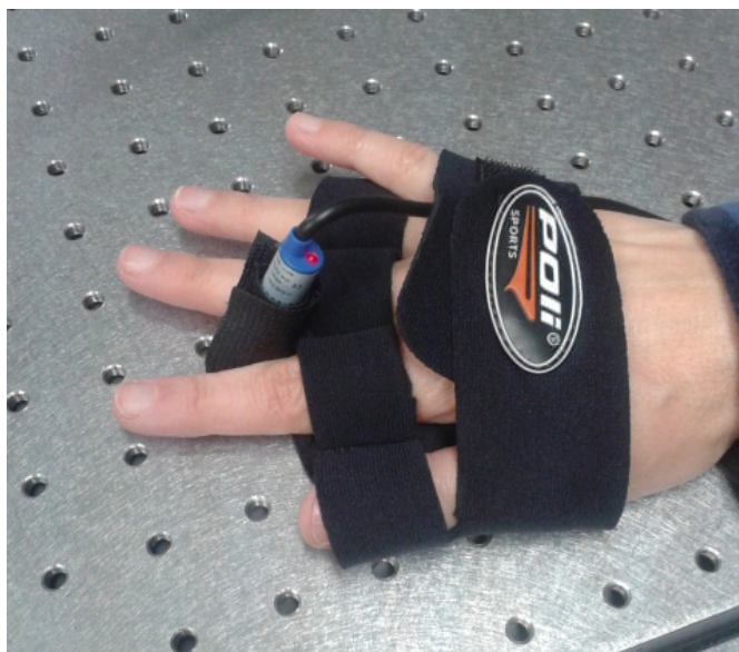
FIGURA 30 – Luva de neoprene com sensor indutivo aderido.
