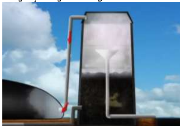
Figura 3 – Representação esquemática da geração do gás no biodigestor.
