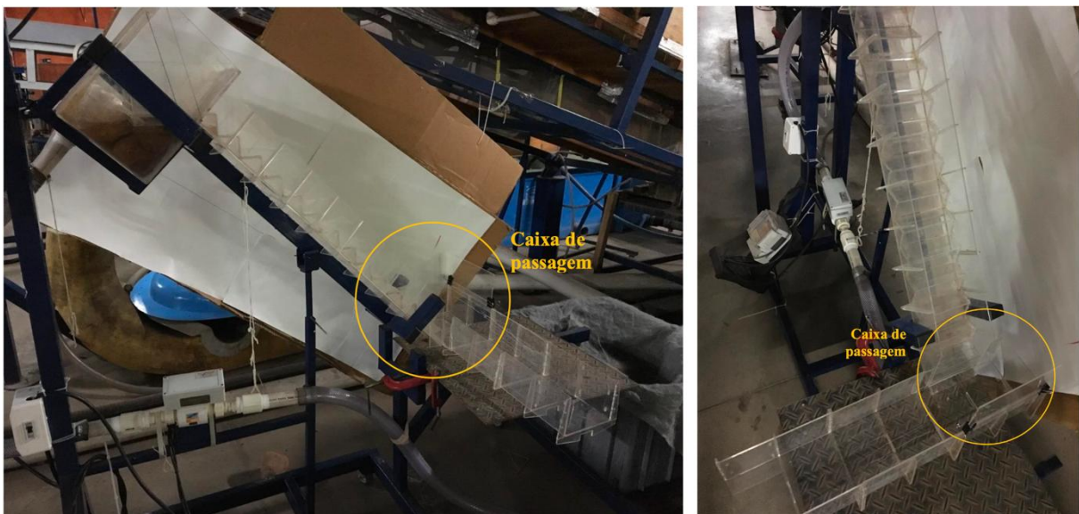
Figura 7 – Modelo experimental na configuração de deflexão de 90°
