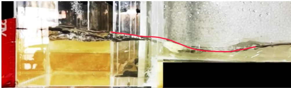
Figura 51 – Queda na profundidade na saída da deflexão – 1,58 L/s – 90° – C
