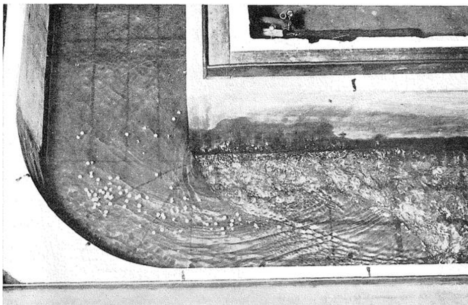
Figura 10 – Formação de ressalto hidráulico e de ondas transversais, ou ondas de choque, a jusante da deflexão – Fr = 0,3395
