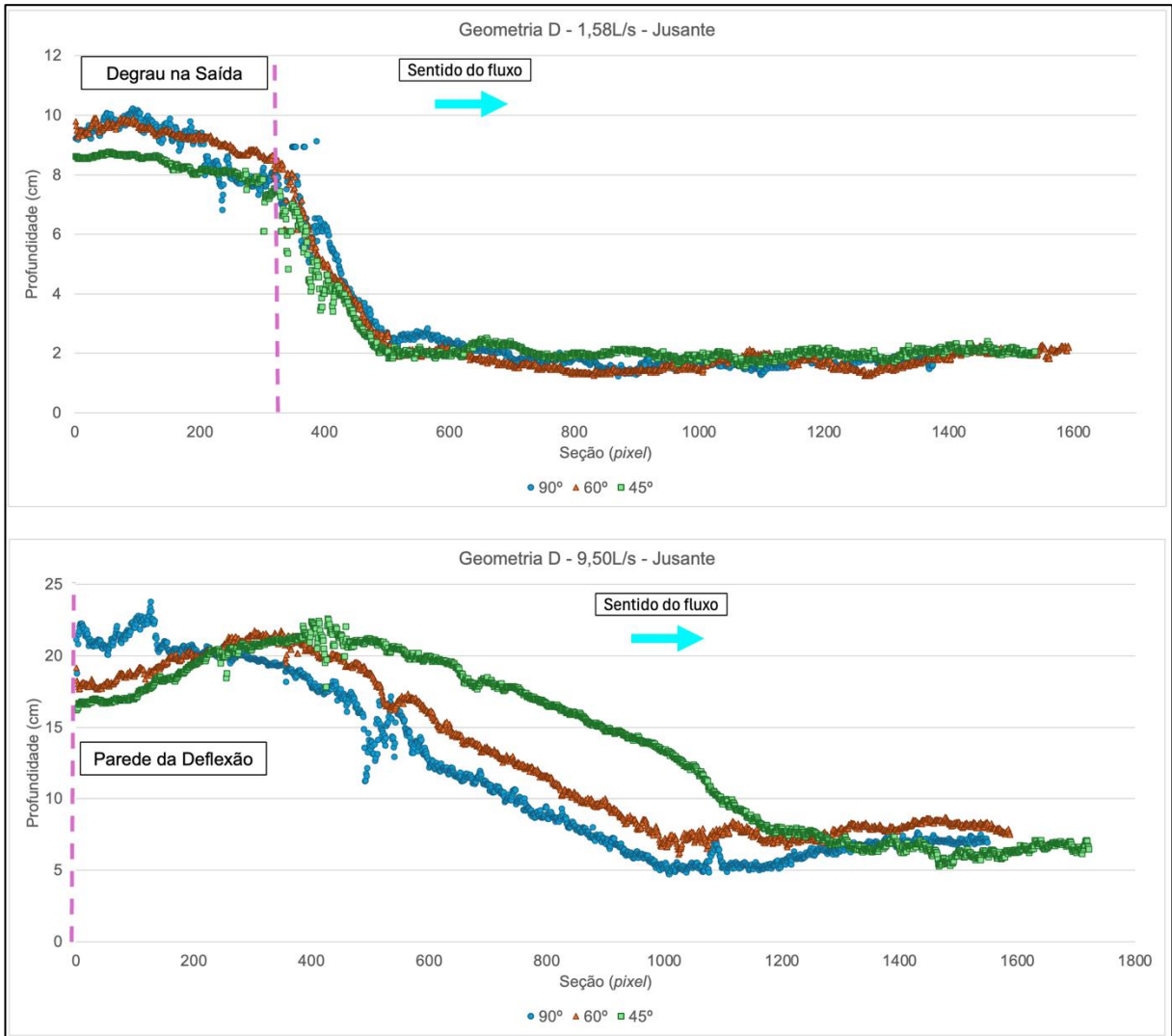
Figura 77 – Perfis da linha d'água para cada ângulo de deflexão – Geometria D – Jusante
