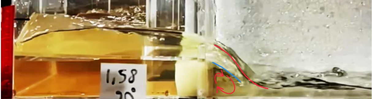
Figura 60 – Descolamento do fluxo e vórtice de recirculação – 90° – 1,58 L/s – D
