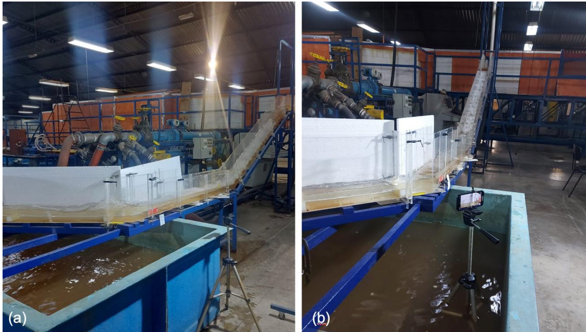
Figura 19 – Posicionamento da câmera em relação ao modelo no trecho de montante (a) e no trecho de jusante (b)
