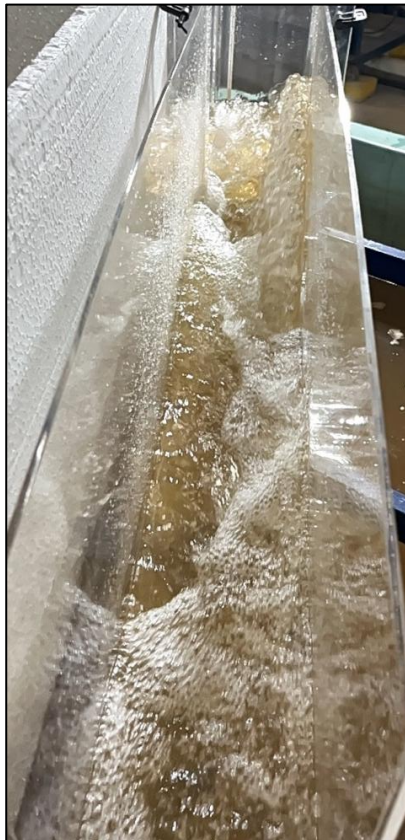
Figura 69 – Formação de ondas transversais – vista superior, geometria D – 60° – Q = 6,96L/s
