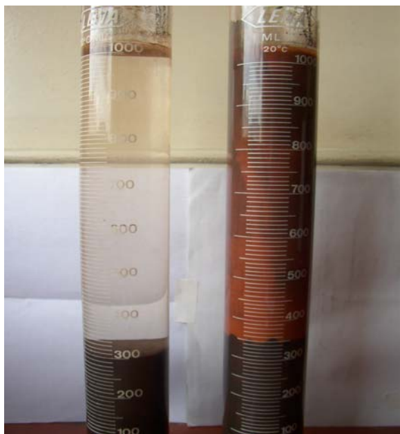
Figura 5.17 – Testes de sedimentação com hematita e 2g/t de poliacrilamida catiônica ou 450g/t de amido
