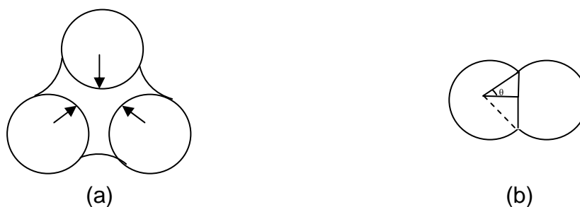
Figura 2.8: Coalescência por capilaridade (a) e por tensão superficial (b)
