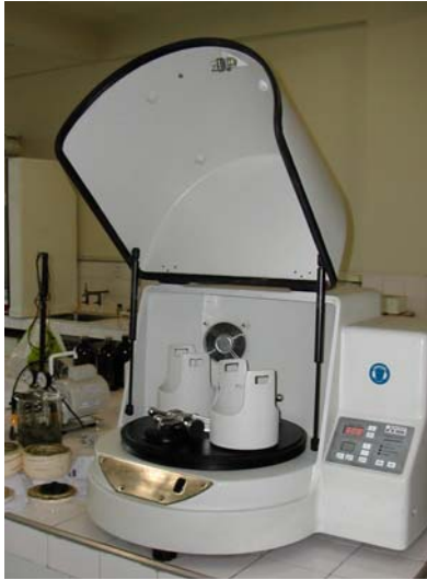
Figura 4.6 – Foto do moinho de bolas e acessórios usados no preparo das amostras
