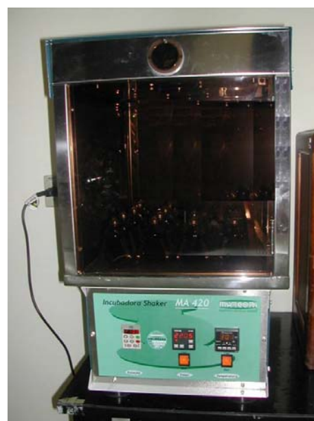
Figura 4.11 – Incubadora shaker usada nos testes de fração biodegradada anaerobiamente
