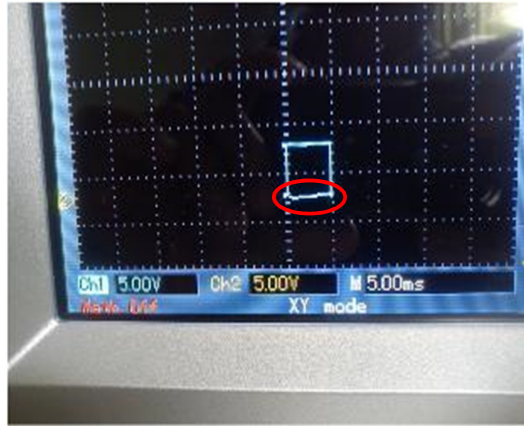
Fig. 5.19 - Figura de Lissajous para os sinais de saída do encoder.
