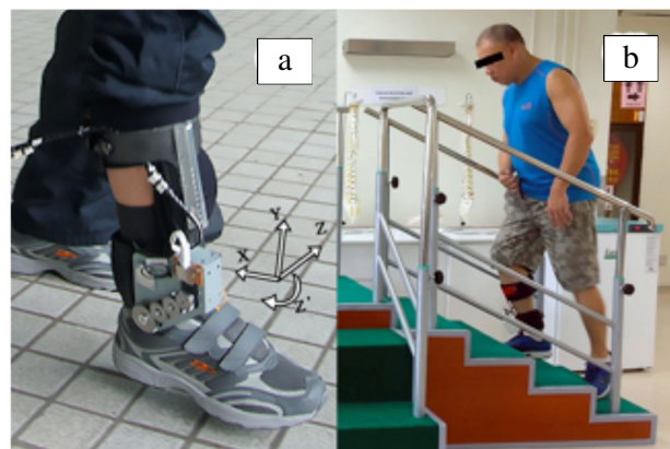
Fig. 2.21 – (a) Paciente vestindo o exoesqueleto (b) Paciente subindo uma escada (Yeung et al, 2017)
