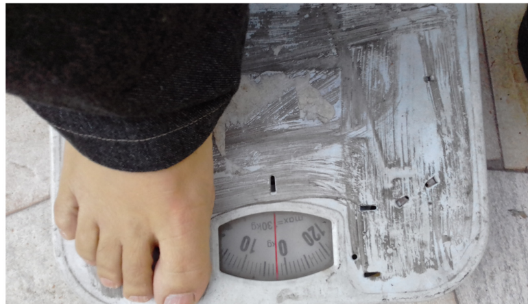
Fig 5.22 - Processo de calibração do sensor de força, detecção do Offset.
