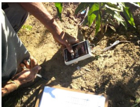
Figura 41: Leitura do aparelho e registro das medições de umidade no solo
