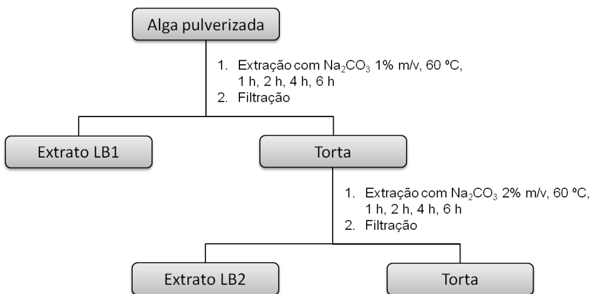
Figura 3.2 – Representação esquemática do processo de extrações alcalinas sequenciais de L. muelleri .
