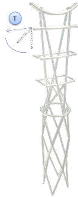
Figura 7.2: Movimentação da cadeia de isoladores.
