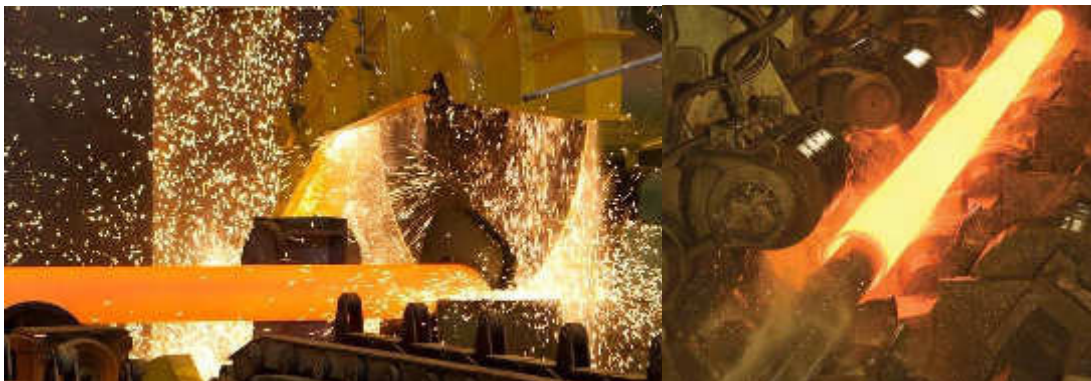
Figura 5.9: Processo de fabricação dos perfis tubulares circulares da Vallourec.
