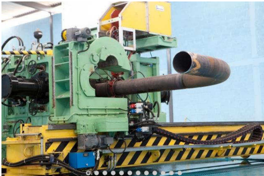
Figura 5.10: Curvamento de perfis circulares. (Fonte: sertub.com.br)
