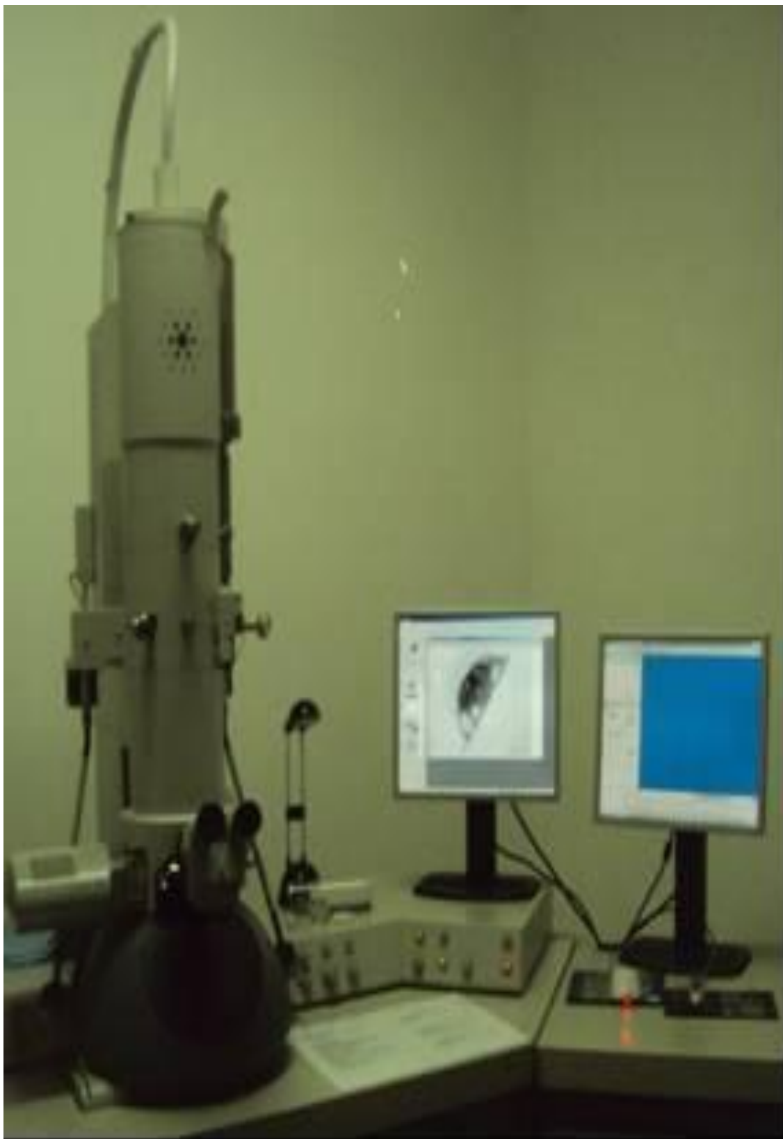
Figura 2: Microscópio eletrônico de transmissão Modelo Morgagni 268 Universidade Estadual de Santa Cruz/UESC – Ilhéus – Ba.
