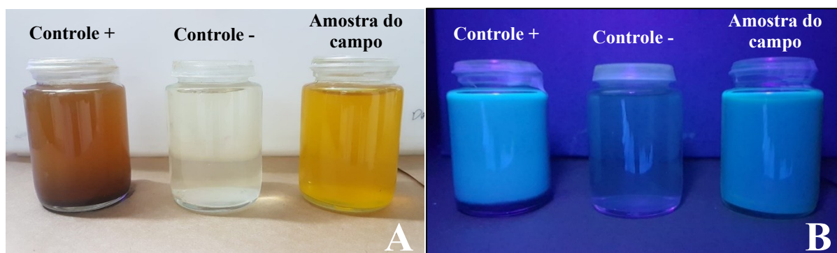
Figura 38. Análise da água com Kit Colilert, para a detecção (A) de coliforme totais em iluminação comum e (B) Escherichia coli com exposição das amostras a luz ultravioleta de 365 nm. Fonte: arquivo pessoal.
