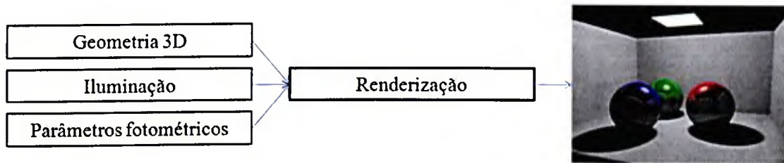
Figura 1.1: Método básico de renderização de uma imagem. Tem como entrada as informações de geometria, iluminação e reflectometria (parâmetros fotométricos) da cena.
