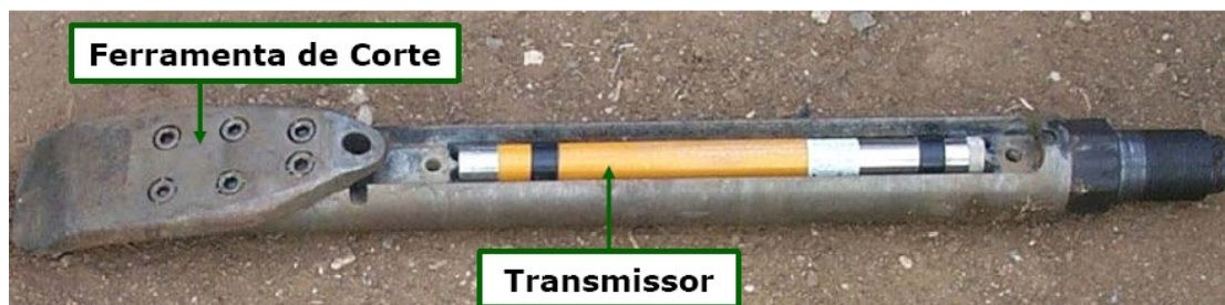
Figura 3.30: Cabeça de perfuração, com detalhe para a ferramenta de corte e para o transmissor/sonda.
