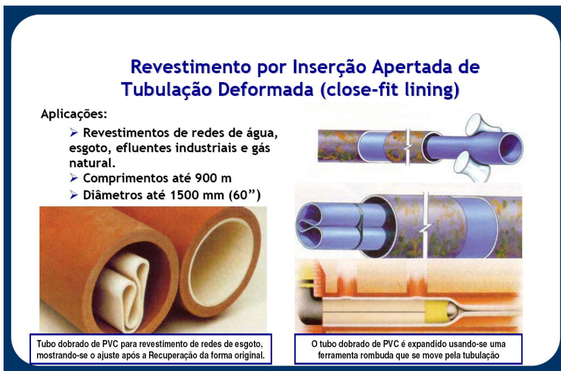
Figura 3.13: Técnica empregada no close-fit lining . Fonte: http://www.abratt.org.br/seminario/intro.pdf . Acesso em 15/11/2014.
