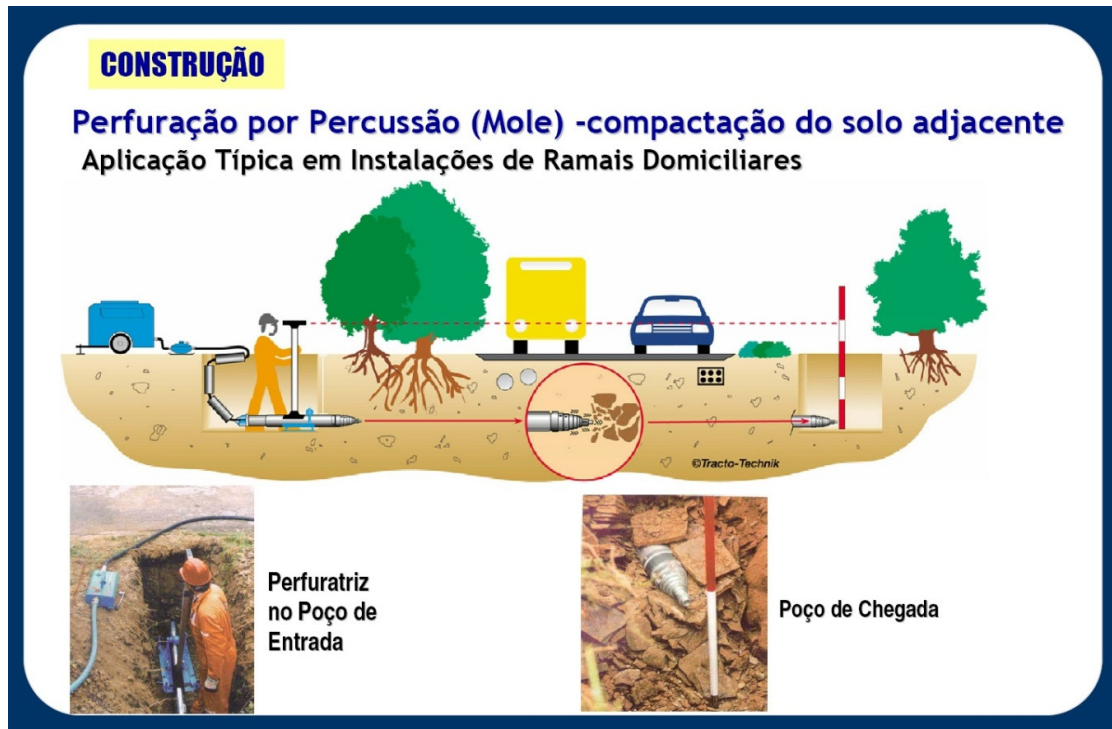
Figura 3.18: Método de cravação de tubos por percussão – impact moling . Retirado de: http://www.abratt.org.br/seminario/intro.pdf . Acesso em 15/11/2014.
